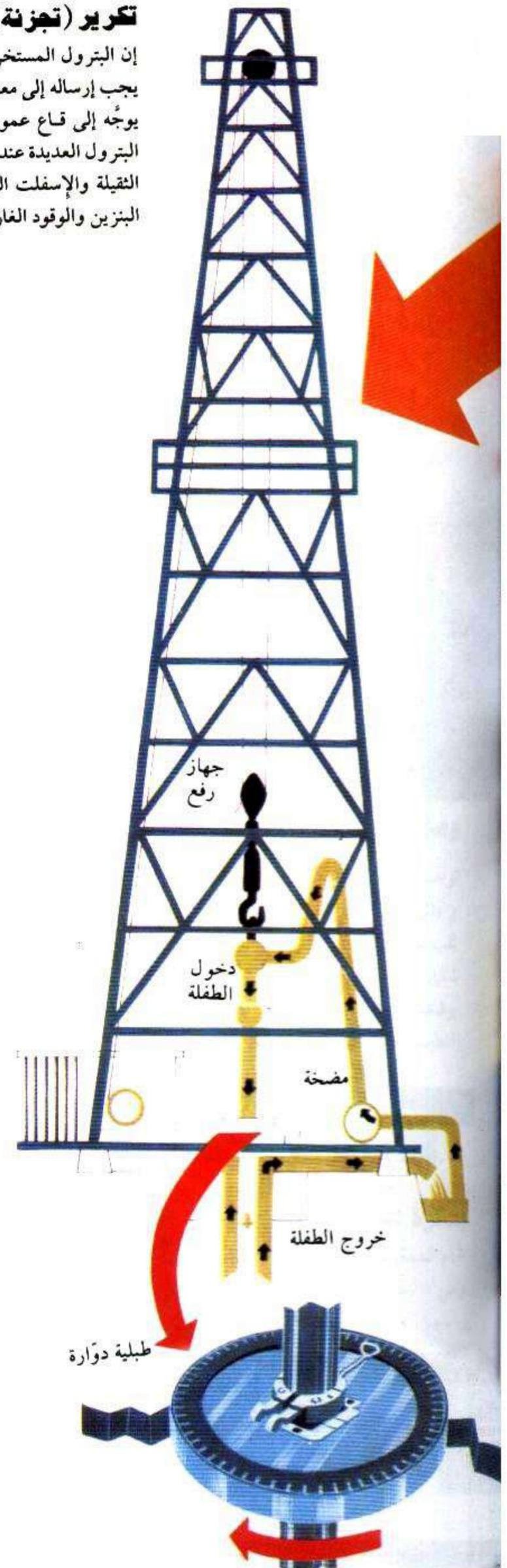
توضح الصورة العليا كيفية العمل التي يعمل بها برج الحفر. وتقوم الأجهزة الرافعة بخفض ورفع القطاعات الجديدة من الأنابيب. وتدار الصينية (الطبلية) الدوارة بواسطة محرك. وهي تمسك بالأنبوبة وتديرها.
