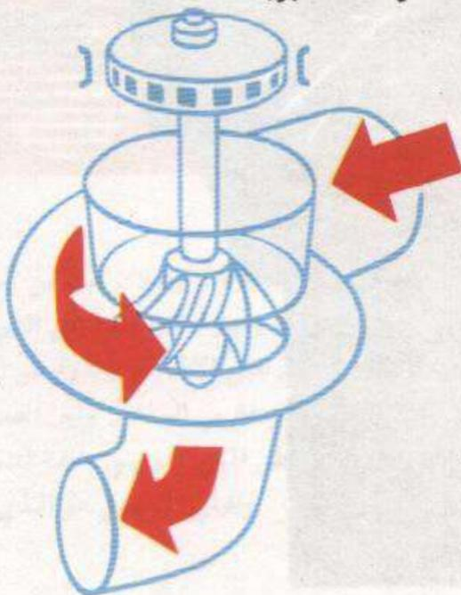
يمكن استغلال قدرة مساقط المياه في إدارة التربينات المائية . والتربينات مولدات الكهرباء .
